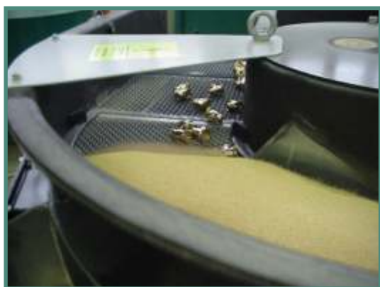
RWO-AS-3/G - phase de déchargement d'articles en laiton séchés
