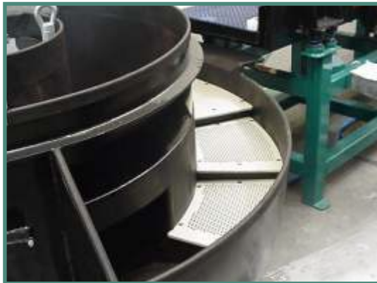
OUTRACE - canal de chargement optionnel pour égouttement externe à la cuve, compatible avec les versions PRO.
