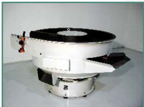
RWO-AS-1/SPU - un sécheur vibrant de grande capacité, approprié pour travailler à cycle continu ou par lots.
