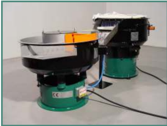
RWO-SA-220 + SlideWay + AS-4-GM/SR - exemple de configuration d'installation complète, avec les machines automatiques les plus petites de la gamme.
