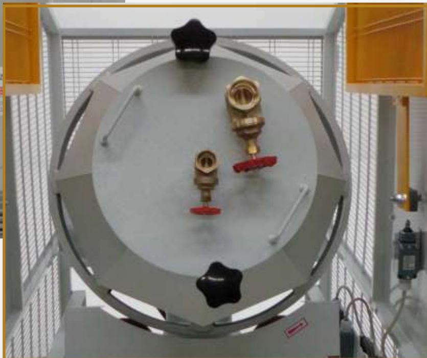
Ogni Buratto RB è disponibile con controllo elettronico di velocità, con estensione della sigla PMP. Di serie il coperchio viene fornito con un filtro di scarico centrale, dotato di tappo a vite in polimero. Per il fissaggio al barile il coperchio è dotato di due viti. E' raccomandabile, nei processi a umido, prevedere (a cura del cliente) una griglia sul pavimento per il drenaggio dei reflui.
