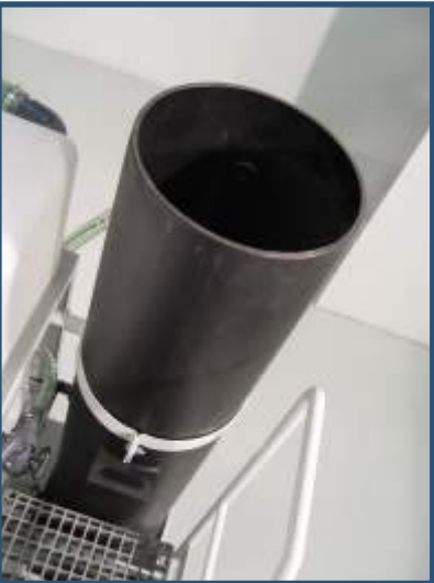
Lato de carga superior de la columna de carbón activado. La columna es de tipo "de gravedad", hecha de HDPE.
