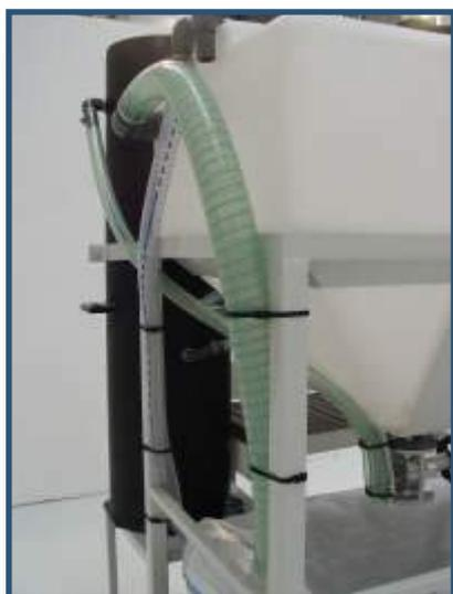
Sur le dessus de la cuve est prévu un « trop plein » de sûreté, raccordé avec tuyaux appropriés au sac filtre.
