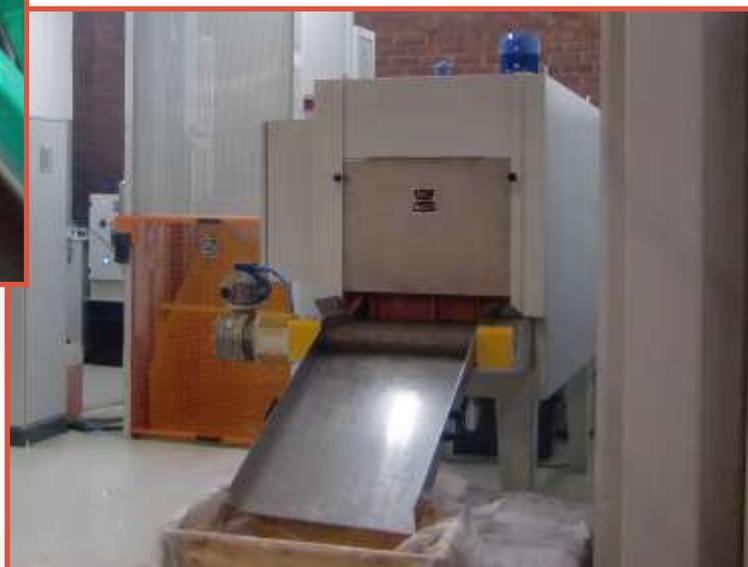
Tunnel di asciugatura ad aria calda, a tappeto, con riscaldamento elettrico. La serie Drytun di Rollwasch® si distingue per tappeti inox a maglia finissima [XS].
