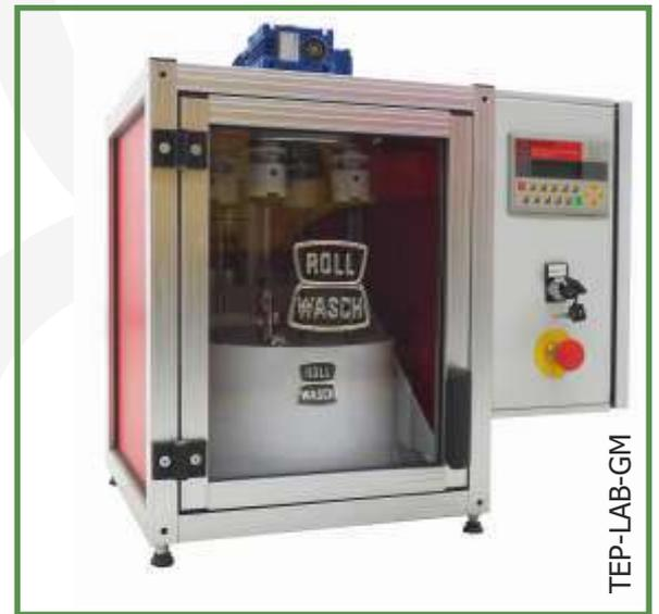
**La serie TEP-LAB permite llevar a cabo en el laboratorio el trabajo de acabado equivalente al de una máquina de tipo industrial.**
