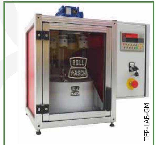
**La série TEP-LAB permet d'effectuer en laboratoire le procédé de finition équivalent d'une machine de type industriel.**
