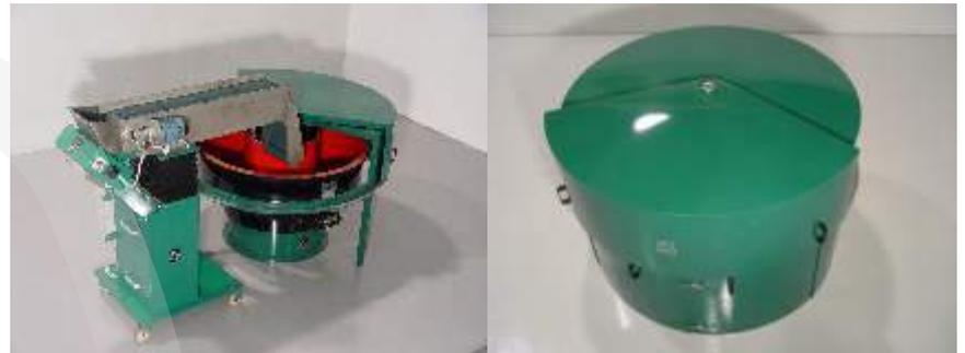
A sinistra una copertura insonorizzante serie AFOCOP-FX e un esempio di estrattore magnetico serie ESMA-D; a destra una copertura insonorizzante chiusa fino in basso, serie AFOCOP-BOX.
