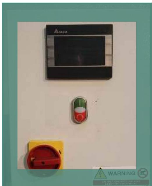
[ 1 ] Vista frontale del quadro comandi serie MP/MPE, nella versione 230V - 50HZ oppure 400V -50 Hz a secondo del modello della macchina.
