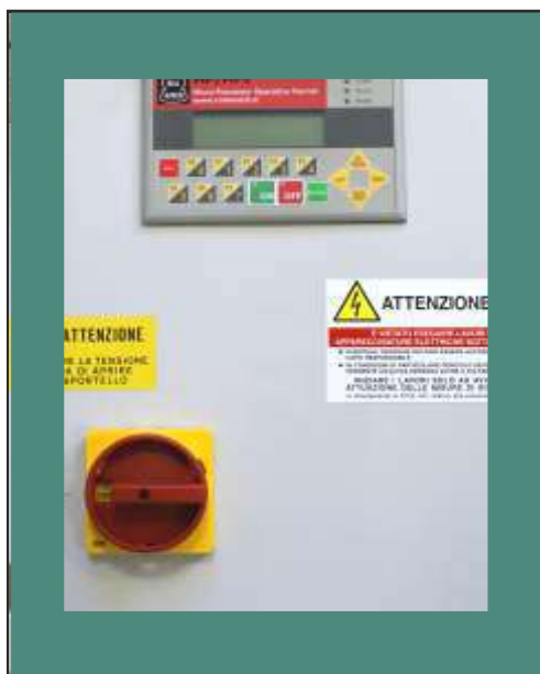
Vista frontale del quadro comandi serie MP/MPE, nella versione 230V - 50Hz oppure 400V -50 Hz a seconda del modello della macchina.
