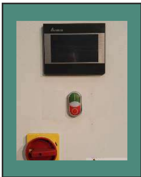
Vista frontale del quadro comandi serie TCS, nella versione 230V - 50Hz oppure 400V -50 Hz a seconda del modello della macchina.
