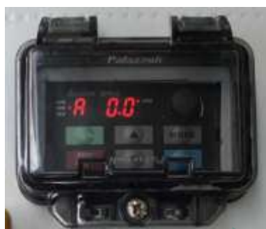
Tastierino funzione per quadro elettrico versione MP-GM.
