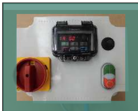
Vista frontale del quadro comandi serie MP-GM, 230V - 50Hz - monofase.
