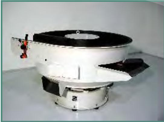
RWO-AS-1/SPU - Ein Vibrationstrockner mit großem Fassungsvermögen, geeignet für den Einsatz mit kontinuierlichem Zyklus oder für Chargen.
