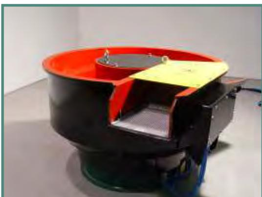
RWO-AS-3/P + 2PNEU-FLAPS-AS3 - Mit mit Form gegossenem Polyurethan verkleideter Behälter und doppelte pneumatische Klappe (Option).
