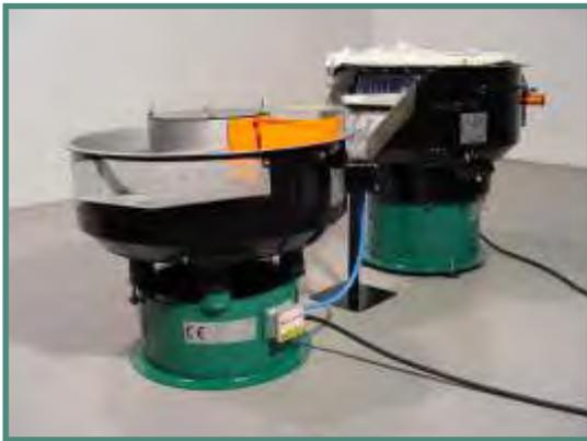
RWO-SA-220 + SlideWay + AS-4-GM/SR - Beispiel der kompletten Anlagenkonfiguration mit den kleinsten Automatikmaschinen des Angebots.
