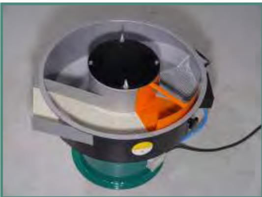
RWO-AS-4-GM/SR - die kleinste Version, ohne Verkleidung, mit abnehmbarer „Brücken“-Klappe.
