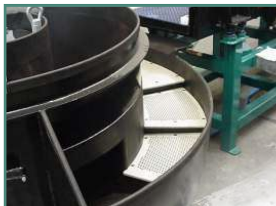
OUTRACE – canal de goteo opcional colocado afuera de la cuba, compatible con la versión PRO.
