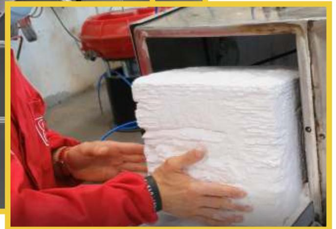
La gamme de machines **VibroBLAST Air [DP] DCK** est conçue pour assurer un large processus MULTITASKING adapté au POST TRAITEMENT après les machines de frittage laser sélectif SLS. En partant d'un **Cake-SLS** avant l'opération de désagrégation, normalement réalisée à la main et suivie d'un sablage manuel ou rotatif, la nouvelle gamme de machines **VibroBLAST Air [DP] DCK** peut fournir automatiquement:
