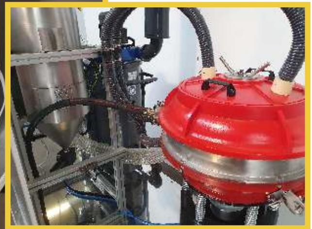
La linea VibroBLAST Air DP nella foto sopra in versione con aspiratore filtro ATEX (certif. entro 2021) è progettata e realizzata per essere fornita montata su pallet tecnologico, per renderne immediata l'installazione con una semplice operazione di plug-&-play.
