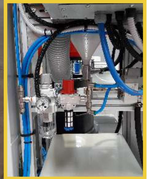
Die **VibroBLAST Air DP** Serie wurde so konzipiert und gebaut, dass sie montiert auf einer technologischen Palette geliefert wird, um sofort mit einem einfachen **Plug & Play** Verfahren installiert werden zu können. Schließen Sie einfach Luft (6 Bar) und die Euro-Steckdose an die vorbereitete Leitung an. Die Maschine kann so arbeiten, wie sie während der Testphase, bevor Sie das Werk verlassen hat, programmiert wurde. Dabei wird besonders auf Bauqualität, Sicherheit und Ergonomie Wert gelegt.
