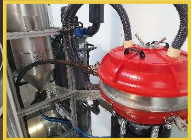
Die **VibroBLAST Air DP**-Reihe im oberen Bild mit Saugfilter in der **ATEX Version** (Zertifizierung voraussichtlich 2021) ist für die Lieferung auf einer technologischen Palette konzipiert und hergestellt, um die Installation sofort durch einen einfachen **Plug-and-Play**-Vorgang zu ermöglichen.
