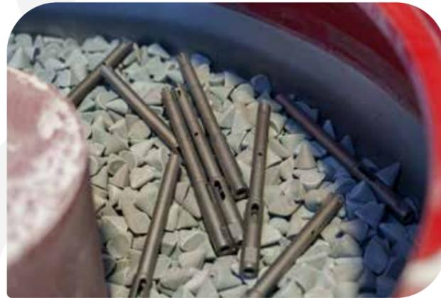
Esta tecnología ahora está protegida por tres patentes internacionales, una relacionada con el tipo de media de vibroacabado "vectorial" elástico, llamado QF, que se utiliza para mover los componentes de forma tridimensional y delicada dentro de la cuba de vibroacabado; otra patente para la tecnología de vibro-chorreado y una última patente para el método de contención de la contaminación de superficies destinadas al sector médico o alimentario.
