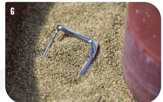
Otros ejemplos típicos de los llamados procesos «EN SECO» pueden ser: desbarbado y/o pulido por autotamboreamiento pieza contra pieza (A); desbarbado y/o alisado con media específicos para ciclos en seco tipo QF o HPM (F); alisado fino y/o pulido en seco con granulados impregnados de cremas o pastas especiales (G); Para coordinar las diversas soluciones posibles con las necesidades del proyecto, casi siempre proponemos realizar pruebas de acabado en nuestros laboratorios.
