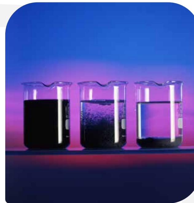
A la izquierda, un ejemplo de la acción de un compuesto floculante, mezclado en la dosis correcta con un agua residual muy contaminada.
