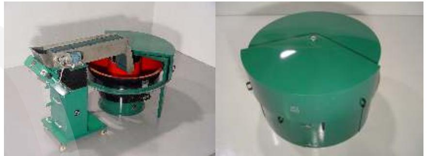
A la izquierda se muestra una tapa modelo AFOCOP-FX y un ejemplo de extractor magnético de la serie ESMA-D. A la derecha hay una tapa de aislamiento acústico cerrada hasta la parte inferior, serie AFOCOP-BOX.
