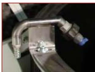
Dans la photo à la gauche, la douche en acier inoxydable pour les modèles Pro, à droite la douche pour l'entrée des liquides en version GM et GL – réalisée en acier peint.;
