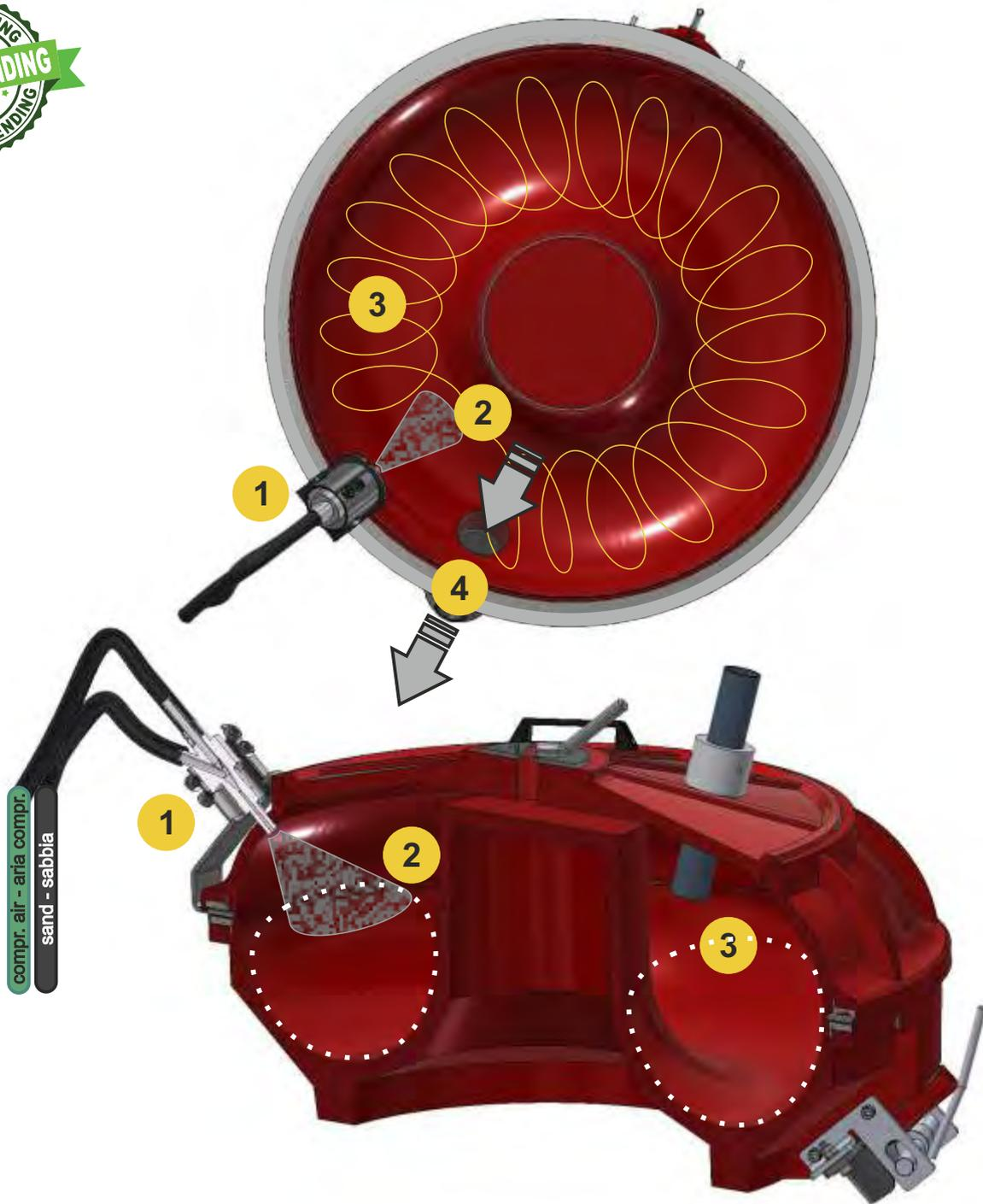
Tutti gli impianti **VibroBLAST Air DP** hanno l'ugello di sabbiatura **SN (Side Nozzle)** posto nell'area superiore della corolla, per coinvolgere dall'alto i componenti trattati, mentre ruotano tridimensionalmente, in senso orario, all'interno della vasca circolare di vibro-sabbiatura.
