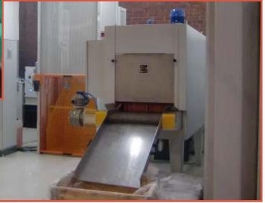
Tunnel de séchage à air chaud, à tapis, avec chauffage électrique. La série Drytun de Rollwasch®se distingue par ses tapis inox à maille très fine [XS]
