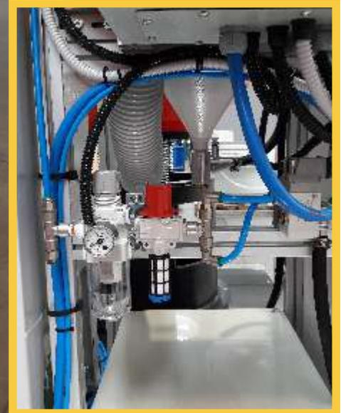
La línea **VibroBLAST Air DP** está diseñada y realizada para ser suministrada montada sobre una paleta tecnológica, para una instalación inmediata con una simple operación de plug-&-play. Simplemente se debe conectar el aire (6 Bar) y la tomacorriente Euro a la línea predispuesta, y la máquina puede comenzar a operar como ha sido programada durante la fase de ensayo antes de salir de la fábrica. Se ha prestado especial atención a la calidad de construcción, seguridad y ergonomía.
