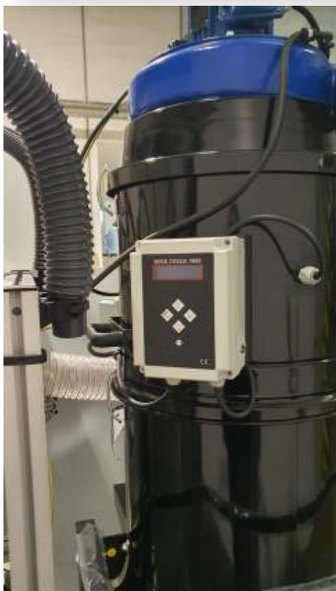
Todos los sistemas Super **VibroBLAST Air DP** han sido diseñados para garantizar una aspiración y filtración excelentes, con nivel ATEX Zona 20 o 22 dentro del grupo aspirador.
