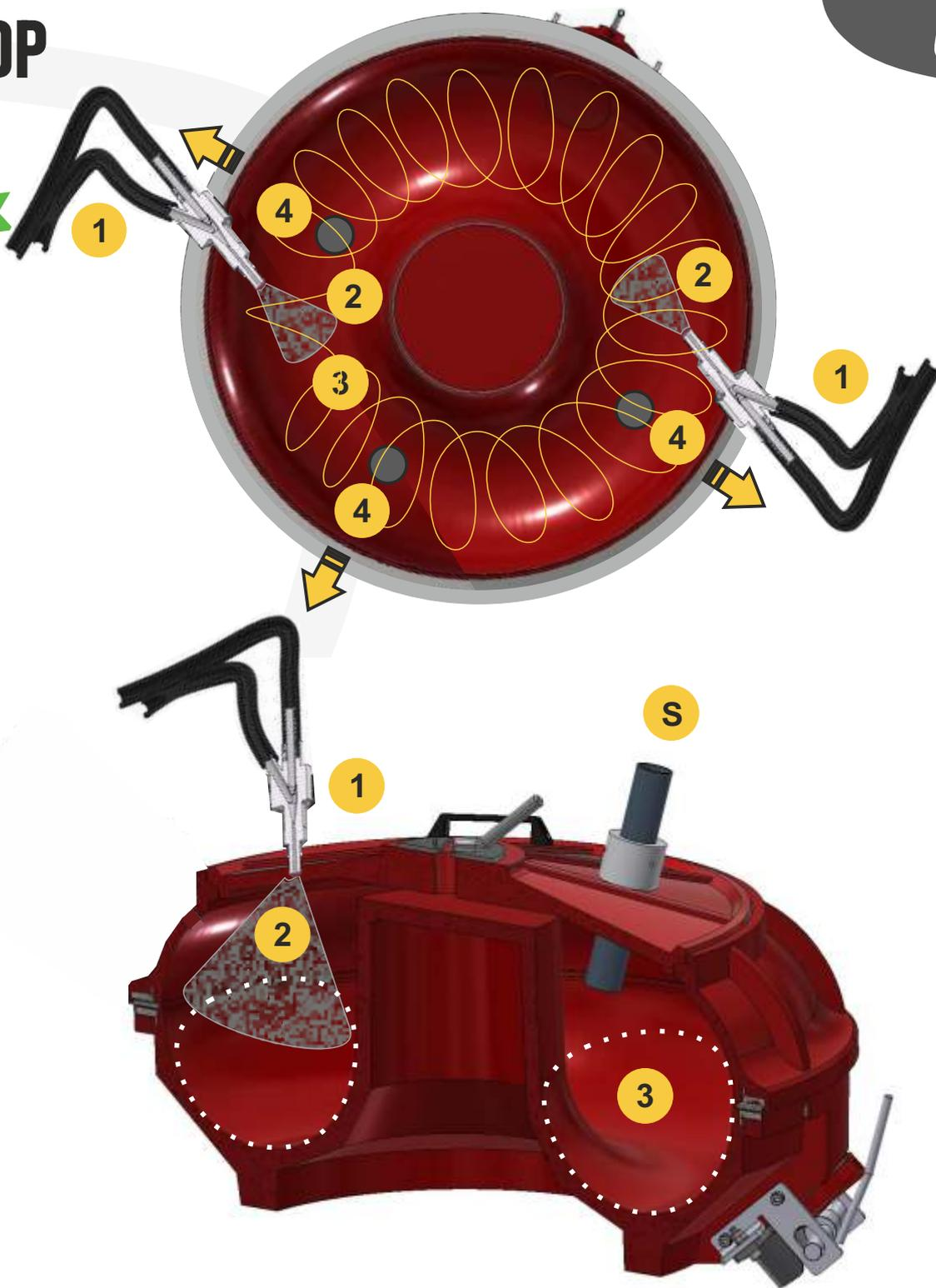
Tutti gli impianti **Super VibroBLAST Air DP** hanno gli ugelli di sabbiatura TN (Top Nozzle) posti nell'area superiore del coperchio, per coinvolgere dall'alto i componenti trattati, mentre ruotano tridimensionalmente, in senso orario, all'interno della vasca circolare di vibro-sabbiatura.
