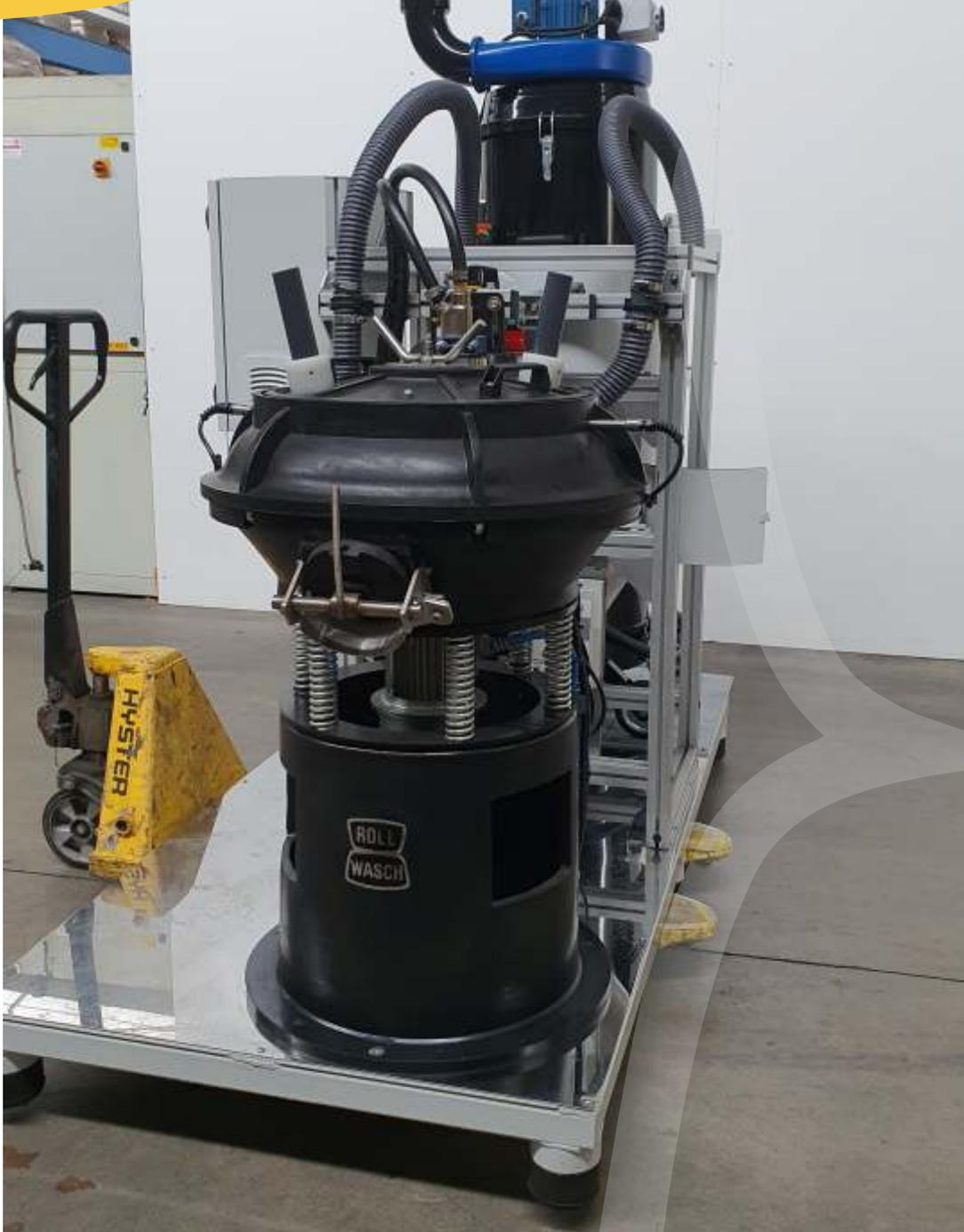
Die **VibroBLAST Air DP** Serie wurde so konzipiert und gebaut, dass sie montiert auf einer technologischen Palette geliefert wird, um sofort mit einem einfachen **Plug & Play** Verfahren installiert werden zu können. Schließen Sie einfach Luft (6 Bar) und die Euro-Steckdose an die vorbereitete Leitung an. Die Maschine kann so arbeiten, wie sie während der Testphase, bevor Sie das Werk verlassen hat, programmiert wurde. Dabei wird besonders auf Bauqualität, Sicherheit und Ergonomie Wert gelegt.
