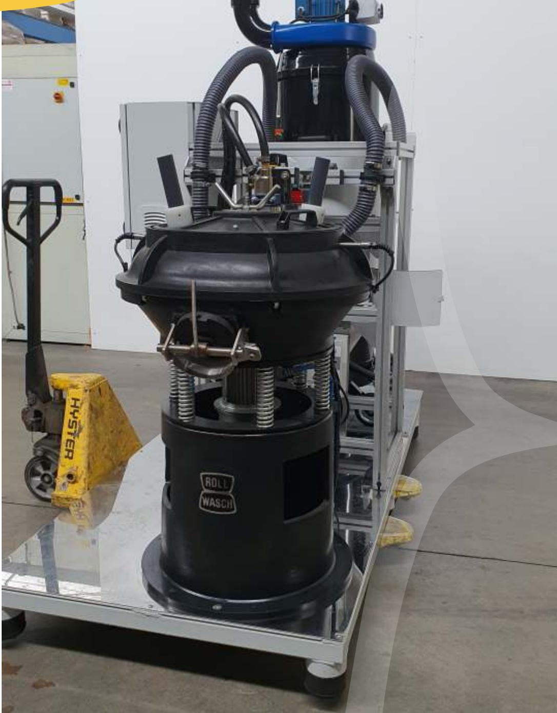
La ligne **VibroBLAST Air DP** est conçue et réalisée pour être fournie montée sur palette technologique, afin de rendre immédiate l'installation avec une simple opération **Plug & Play**.
