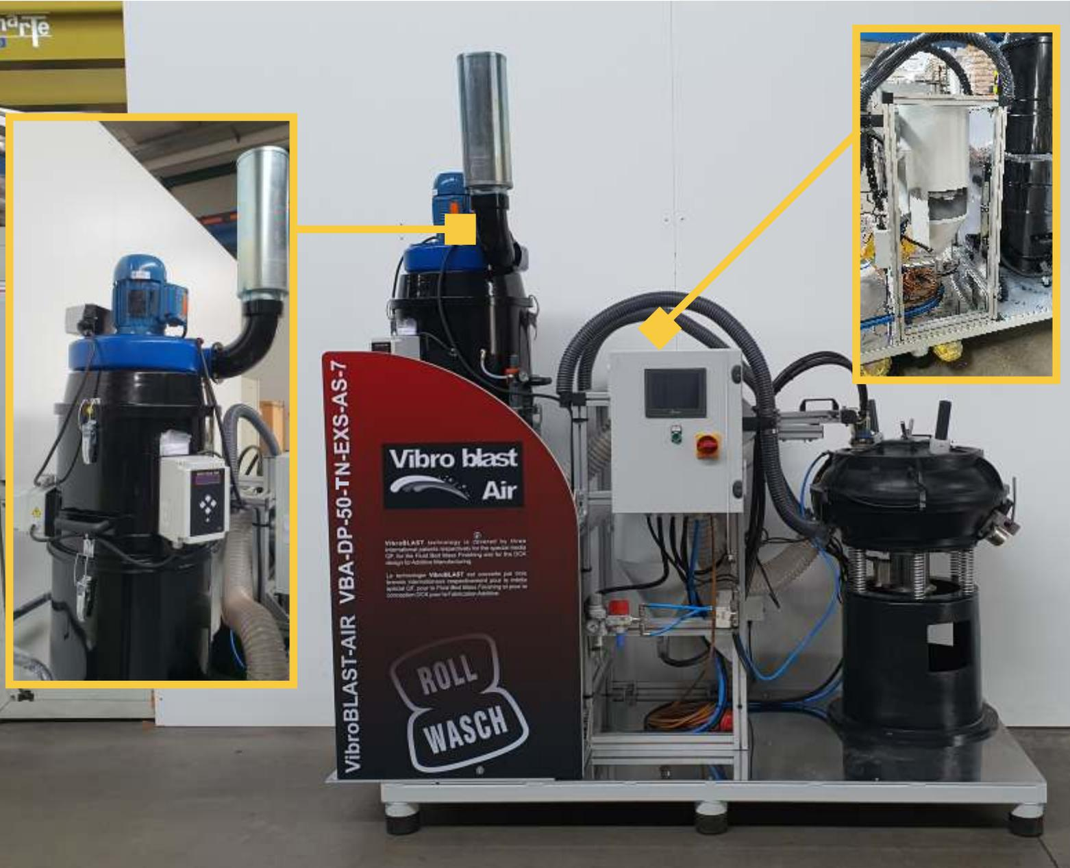
Cette machine avec filtre d'aspiration en version-**ATEX** est basé sur une capacité de 50 litres, vibreur circulaire avec cuve en PU et couvercle, une unité de sablage à dépression/vide avec cyclone et armoire de filtration, un panneau de commande avec inverseur, PLC et écran tactile, un filtre de vidange de sable sur le fond de la bol vibrant.
