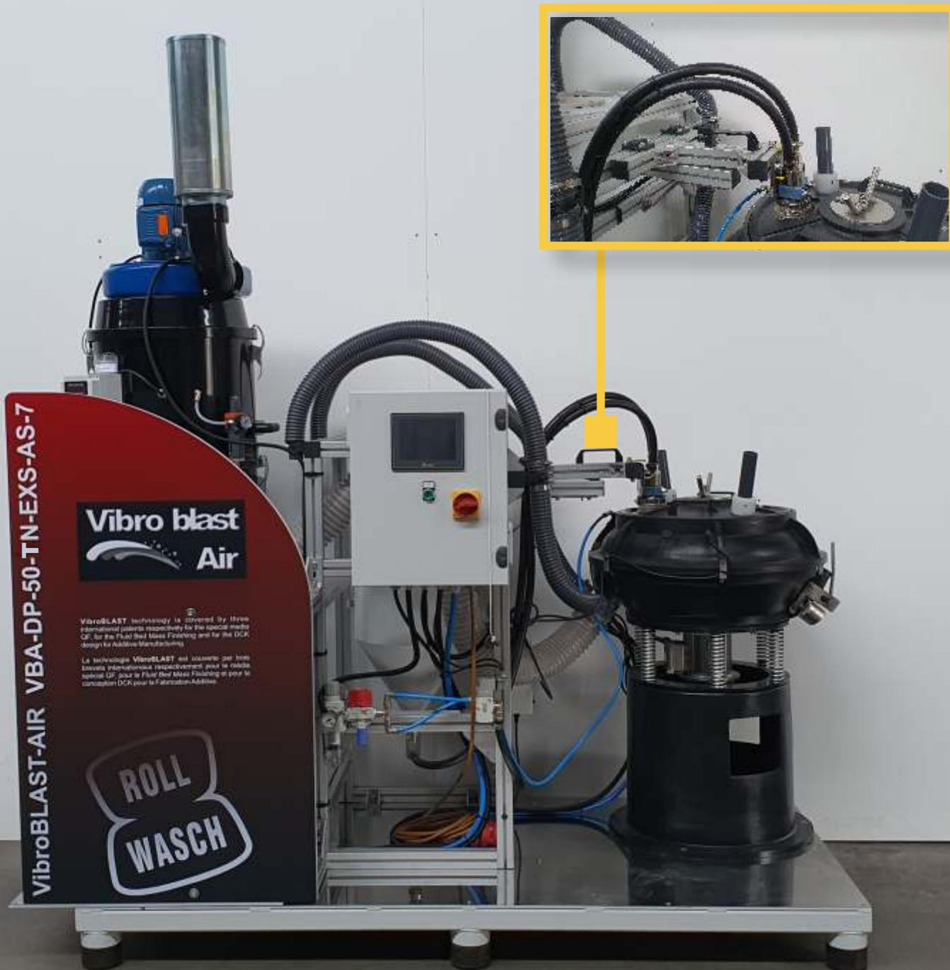
Cette machine est basée sur un vibreur circulaire d'une capacité de 50 litres avec réservoir en PU et couvercle, une unité de sablage à dépression/vide avec cyclone et armoire de filtration, un panneau de commande avec inverseur, PLC et écran tactile, un filtre de vidange de sable sur le fond de la bol vibrant. Sur le couvercle de la machine se trouve un tuba d'entrée d'air, tandis que la buse de sablage est positionnée sur le couvercle (TN – Top Nozzle).
