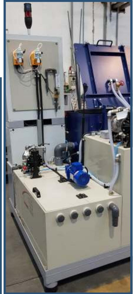
**RFC-20-FLOC ist auch in der Version mit integrierter Vormischungseinheit erhältlich;**
