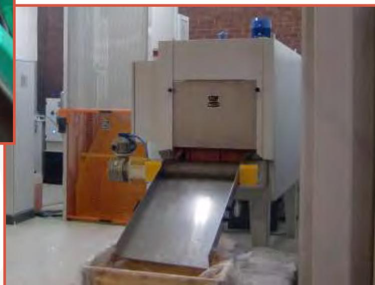
Tunnel di asciugatura ad aria calda, a tappeto, con riscaldamento elettrico. La serie DRYTUN di Rollwasch® si distingue per tappeti inox a maglia finissima [XS].
