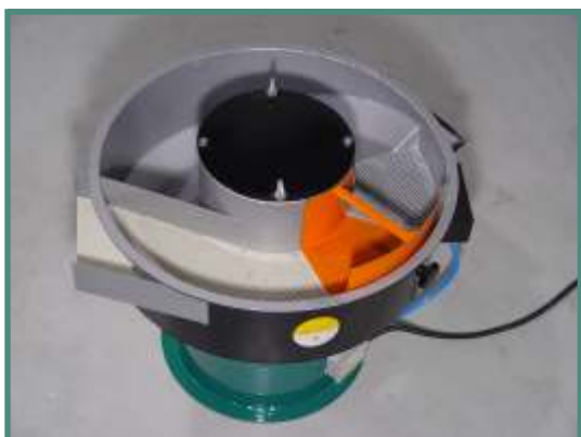
RWO-AS-4-GM/SR - la versión más pequeña, sin recubrimiento y con un flap extraíble "a puente".
